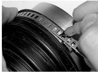
Schritt 2 Ermittlung der Klemmenlänge.
