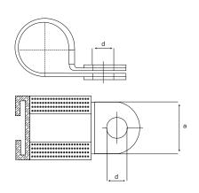
Speziell entwickelt für die Befestigung von Rohren, elektrischen Leitungen und Schläuchen in vielen Anwendungen.
