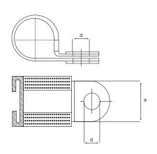
Speziell entwickelt für die Befestigung von Rohren, elektrischen Leitungen und Schläuchen in vielen Anwendungen.
