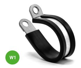
Die Gummiprofilklemmen, im Handel P-Clip genannt, bestehen aus einem verzinkten Stahlband, das mit EPDM-Kunststoff überzogen ist. Dieses Kunststoffprofil ermöglicht eine feste und sichere Verbindung, schützt den Untergrund und beugt möglichen Schäden durch Vibrationen in der Anwendung vor. Das obere Ende der Schraube ist mit einer Platte verstärkt, um einen guten Halt zu gewährleisten.
