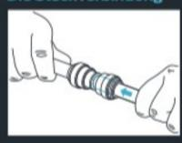
Das Rohr bis zum Anschlag einstecken.
