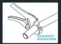
Schneiden Sie das Rohr gerade ab. Verwenden Sie idealerweise eine John Guest Rohrschere für starre Nylonrohre und einen Aluminium-Rohrschneider für Aluminiumrohre. Um eine Beschädigung des O-Rings zu vermeiden, entfernen Sie Grate und scharfe Kanten.
