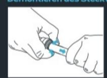
Bevor Sie den Steckverbinder lösen, überprüfen Sie, ob das System drucklos ist. Anschließend kann das Rohr durch Zurückdrücken des Halteelements gelöst bzw. entfernt werden.
