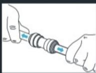
Überprüfen Sie, ob das Rohr sicher eingesteckt ist. Dies ist durch Gegenziehen leicht möglich.
