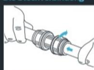
Nach dem Einstecken des Rohres wird durch eine ¼-Umdrehung der Schraubkappe das Halteelement gesichert und somit die Bewegung des Rohres reduziert. Überprüfen Sie durch Gegenziehen, ob das Rohr sicher eingesteckt ist.
