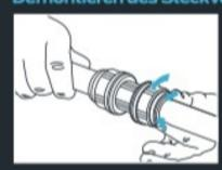
Um die Verbindung zu lösen, muss die Schraubkappe eine ¼-Umdrehung entgegen des Uhrzeigersinnes gedreht werden. Nun ist die Verbindung entsichert und kann durch Drücken des Halteelementes gelöst werden.
