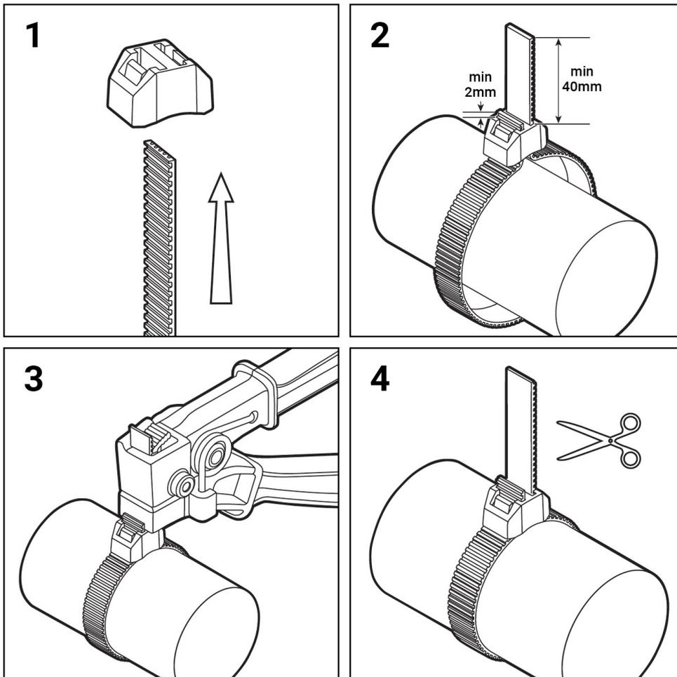
1. Messen Sie die Länge des benötigten Smart® Band Flex und fügen Sie mindestens 45 mm zusätzliches Band hinzu. Führen Sie ein Ende des Bandes in den Verschluss (SB-BU-FX-1/2-LH-POM) ein und lassen Sie es mindestens 2 mm herausragen.
